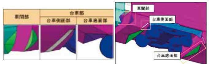
図6：突起フィンの基本形状と取り付け位置
